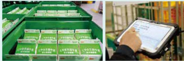
朝5時くらいから商品が続々と入荷してきます。冷凍品は仕分けの前日、冷蔵品は当日朝に入荷し、仕分け作業に入ります。商品の入荷時には、入荷検取タブレットを使い、製造年月日や消費期限・賞味期限に間違いがないか入荷商品と照らし合わせて確認を行います。入荷した商品は、冷蔵5℃、冷凍-25℃に設定された部屋で仕分け作業が始まるまで保管されます。
