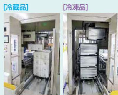
冷蔵品のシッパー、冷凍品のZパックはそれぞれ機械で自動的に台車に積み上げられます。このまま保管庫へ運びます。
