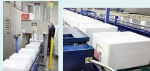
保管されているたくさんのシッパーを「段ばらし機」という機械を通して順番に送り、個人別ラベルが自動で貼られていきます。ラベルには、注文内容などの情報を機械で読み取るためのバーコードが印刷されています。
