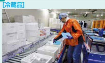
個人別にセットされた冷蔵品は、断熱シートをかぶせて蓄冷剤を投入し、ふたをかぶせていきます。
